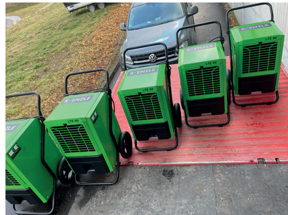
Einsatz von Bautrocknern
